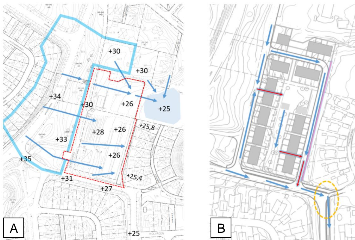
Bild A visar ytavrinning enligt befintliga topografiska förhållanden och bild B visar avrinningsvägar efter exploatering.
