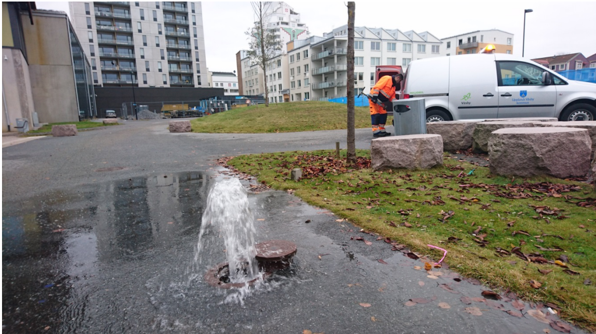
Figur 3 Spolvattenposten, betecknad Brunn A. Ett prov togs efter endast några liters urspolning (A:1) och ett andra prov togs efter att posten spolats ur under drygt en timme (A:2)
