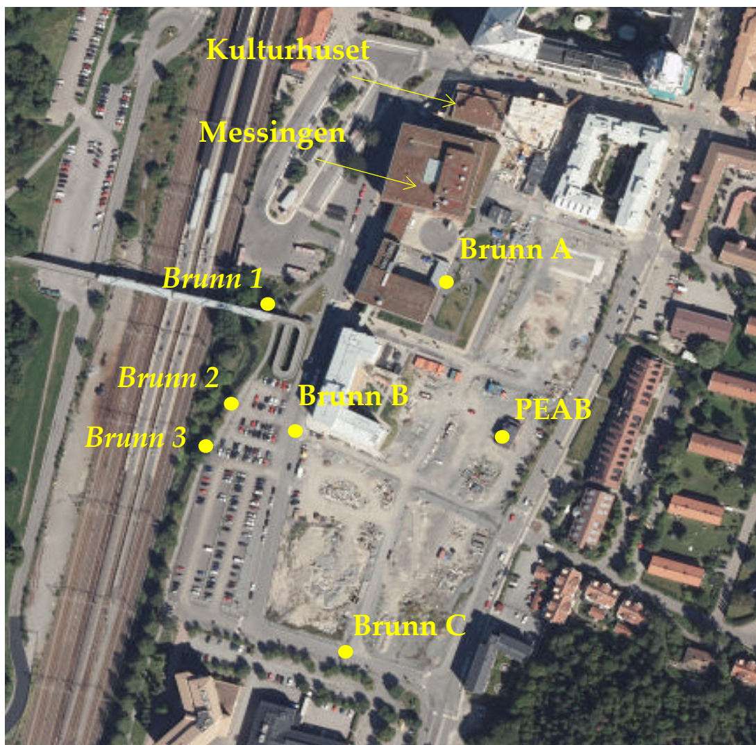
Figur 4 Visar var prover från brunnar och dricksvatten insamlades. I provpunkterna med kursiv text (Brunn 1, 2 och 3) inhämtades sedimentprover, i övriga punkter togs vattenprover. Ett referensprov för dricksvatten inhämtades i Breddensskolan, ca 3 km från Messingen (ej utmärkt i kartan).
