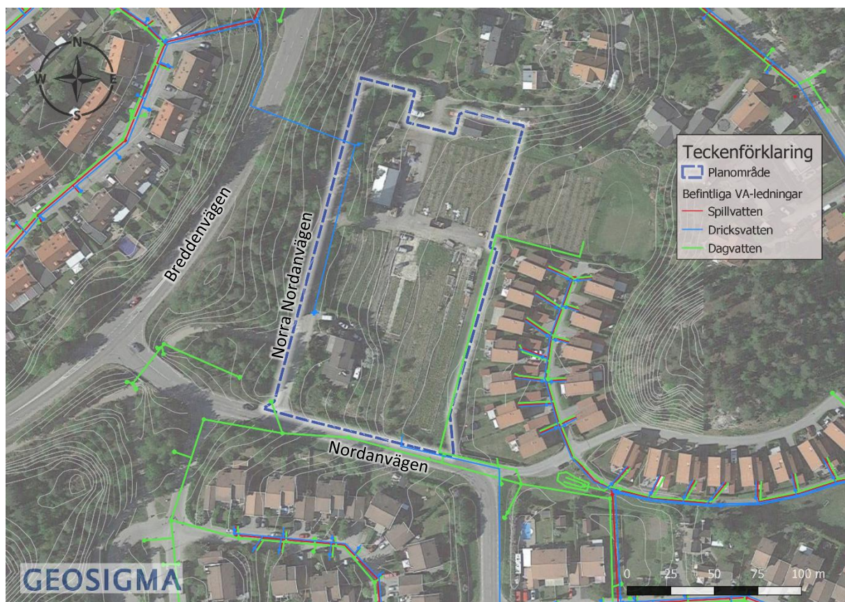
Figur 3-6. Befintliga dagvattenledningar i planområdets närhet.
