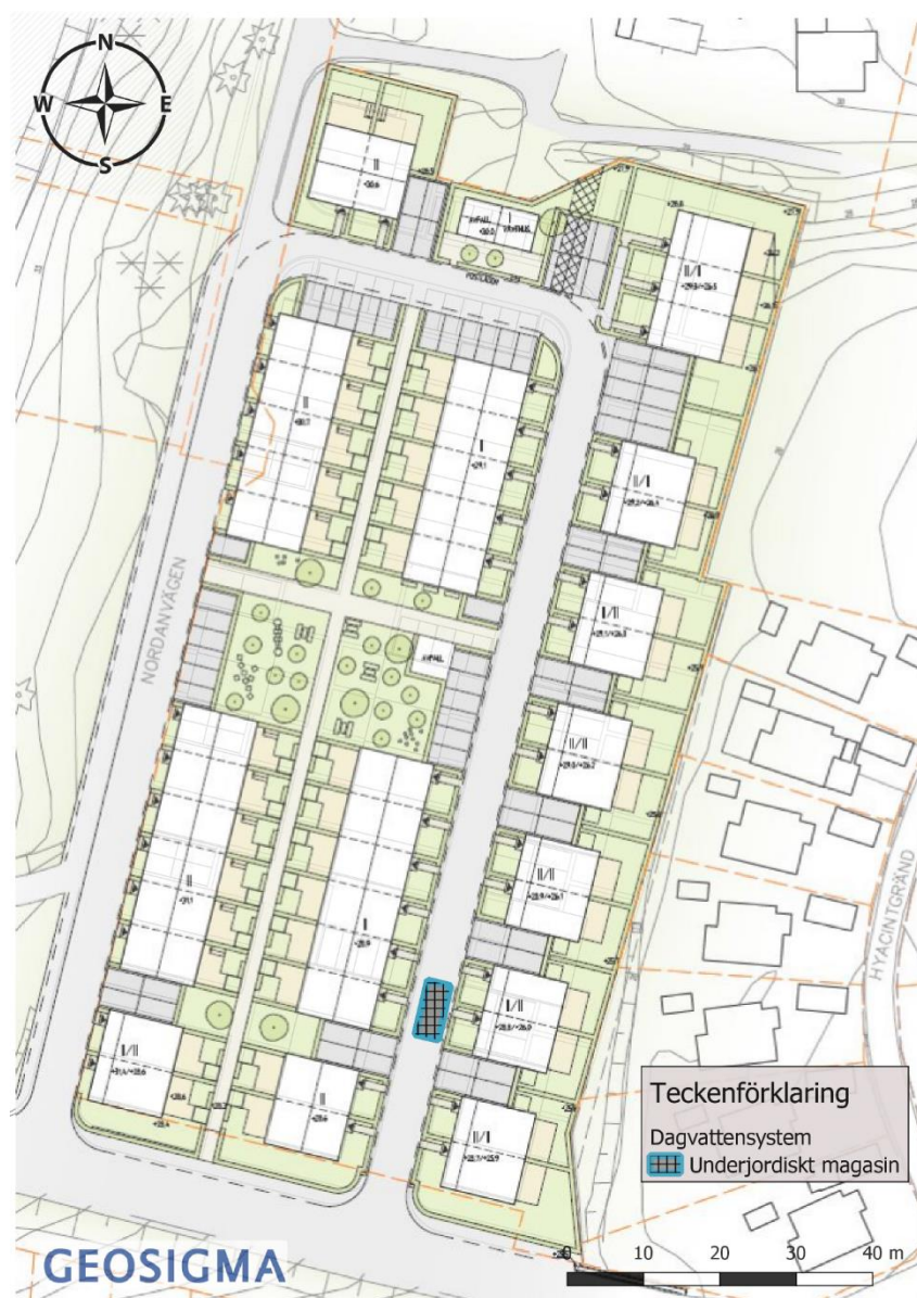
Figur 7-1. En schematisk skiss över föreslagen dagvattenhantering av underjordiskt magasin
